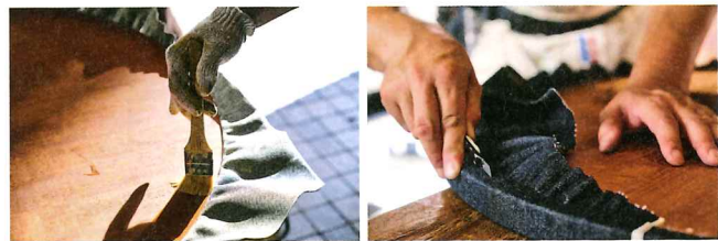
円形の天板にデニムを貼るには、職人の技術が必要となる。皺にならないように貼り付けていく様はさすがプロの職人。粘着シートはそう簡単に剥がれるものではないが、テンションのかかる端に接着剤を付けることでより強固に!
