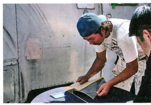
円形の天板にデニムを貼るには、職人の技術が必要となる。皺にならないように貼り付けていく様はさすがプロの職人。粘着シートはそう簡単に剥がれるものではないが、テンションのかかる端に接着剤を付けることでより強固に!
