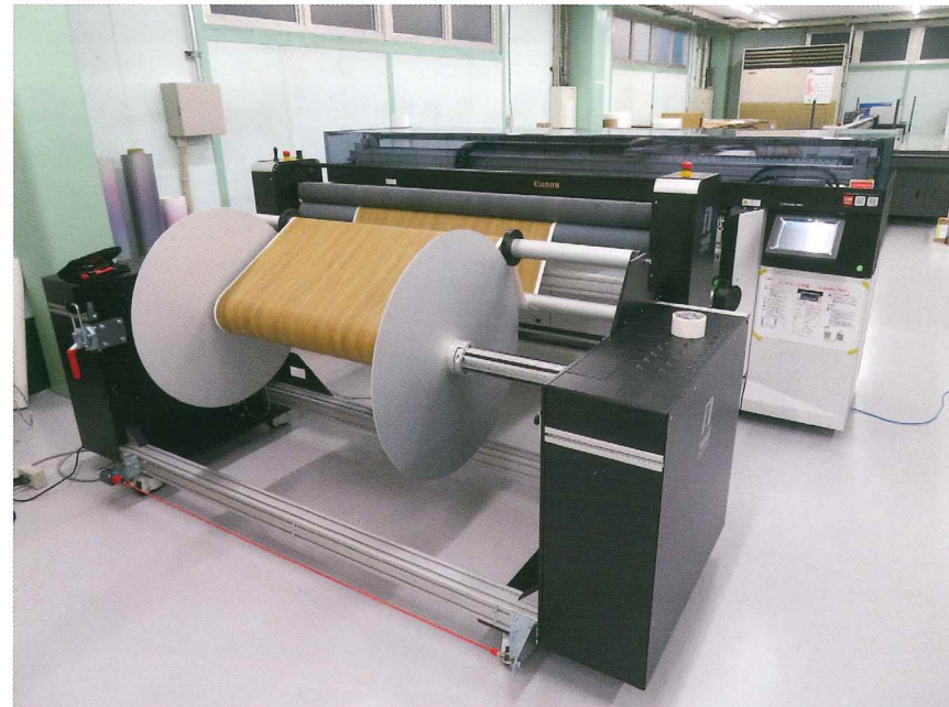
「TOKYO WALLPAPER FACTORY」は「Colorado1650」がベース。イタリアのネオルト社製巻き出し・巻取りを連結。
