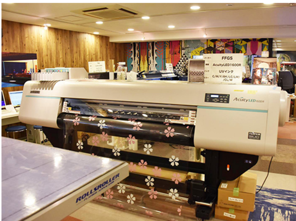
同社で稼働している富士フィルム社製ワイドフォーマット UVインクジェットプリンター「Acuity LED 1600R」
